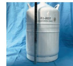
Линейка для измерения уровня жидкого азота
